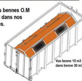
Vue benne 15 m3 dans benne 30 m3
